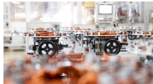
Vollautomatische Produktionslinie für die Fertigung von Statoren mit Einsatz von Runddraht.
