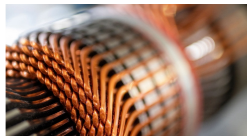
Die Flachdraht Wellenwickeltechnik zeichnet sich durch sehr wenige Schweißpunkte im Drahtverlauf aus. Dies hat zur Folge, dass der Herstellungsprozess sowohl schnell, effizient als auch produktions sicher ist.
